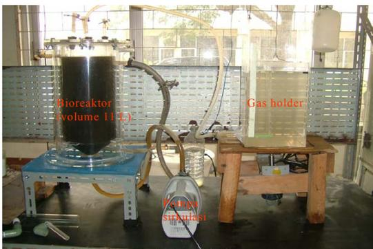
Gambar 5. Rangkaian peralatan pengolahan sludge dengan proses anaerobik
